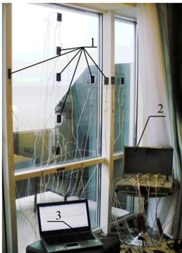
Рис. 3. Размещение ПТП и ПТ ИК «Ресурс» на внешней ограждающей конструкции: 1 – ПТП со встроенными ПТ; 2 – измерительный комплекс «Ресурс-С»; 3 – ПК; 4 – ПТ для измерения температуры поверхности ОК; 5 – ПТ для контроля температуры окружающей среды
