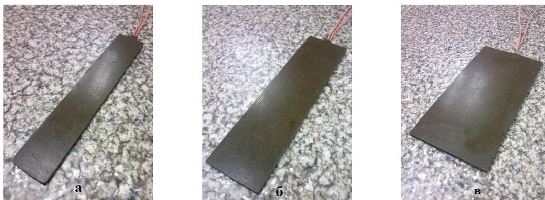
Рис. 2. Внешний вид преобразователя теплового потока с размерами:
