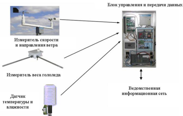
Рис. 5. Структура автоматизированного метеопоста
