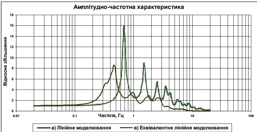
Рис. 1. Амплітудно-частотна характеристика ґрунтового середовища під будівельним майданчиком на перетині вулиць Червоногвардійської та Краківської в м. Києві отримана а) лінійним моделюванням, в) еквівалентним лінійним моделюванням з використанням програмного комплексу ProShake
