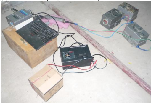
Рис. 1. Цифровий комплекс DAS-05 з датчиками SM3-KB, встановлений в патерні по осі правобережної греблі на відм. 67.000 на пункті ПР6 Параметри експериментальних вибухів наведено у табл. 1.
