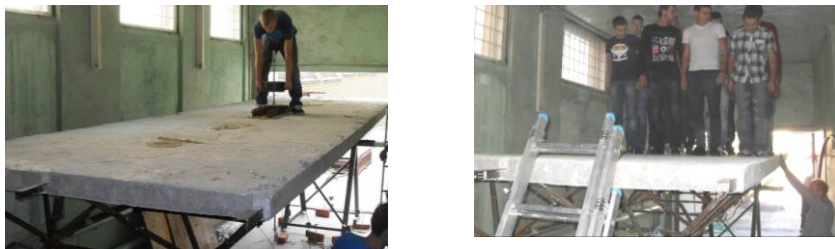
Рис. 3. Динамические испытания пролетного строения
