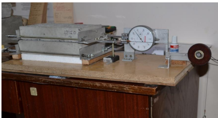
Фото 1. Установка с двумя бетонными образцами
