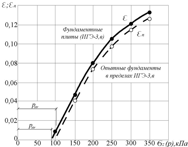
Рис. 3. Зависимости значений относительных деформаций уплотнения в грунтах основания под штампами площадью 0,5 и 1 м<sup>2</sup> (○) и относительных деформаций под фундаментными плитами в верхней половине лессовой супеси (●) (ИГЭ-3,в) в пределах которой проведено большое количество испытаний опытными фундаментами
