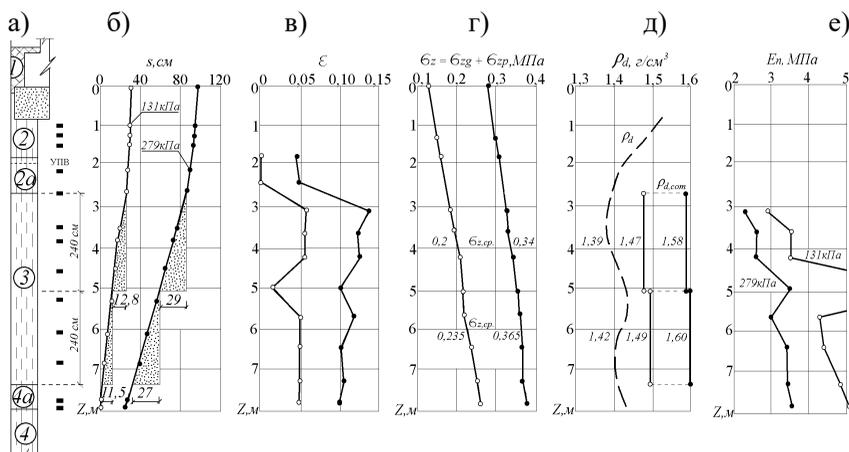
Рис. 1. Развитие деформаций в грунтах основания фундаментной плиты с площадью подошвы  $645m^2$  в слое лессовой супеси (ИГЭ-3);
