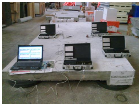
Рис. 2. Лабораторные динамические испытания РСБ
