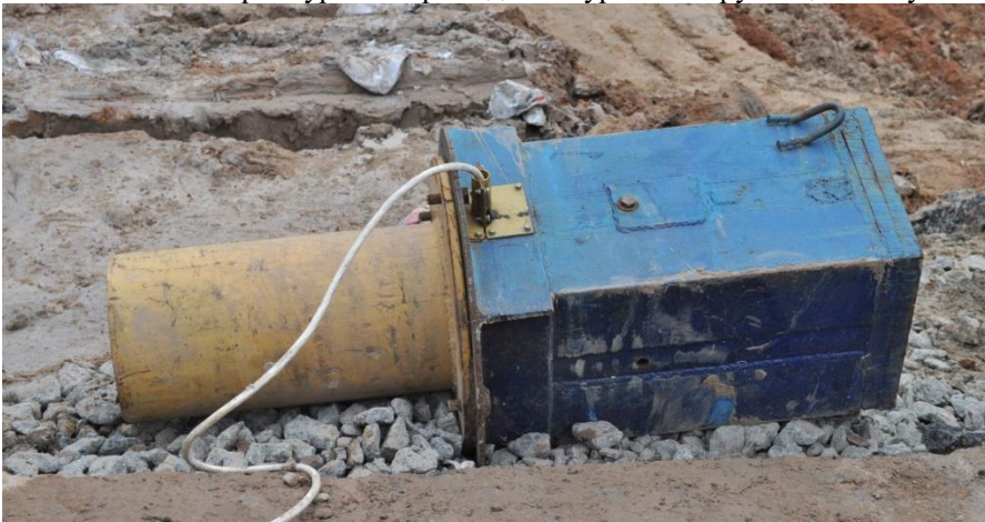
Рис. 2. Вібратор, за допомогою якого виконувалось заглиблення каркасів.
