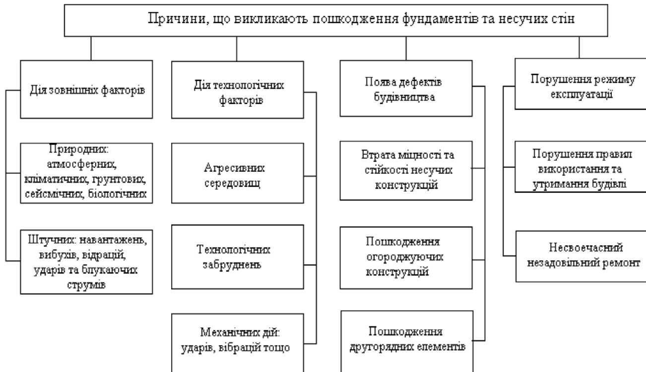
Рис. 1. Причини, що викликають пошкодження фундаментів та несучих стін
