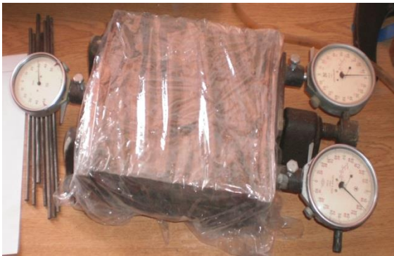
Рис. 3. Форма-пристрій для вимірювання деформацій аутогенної усадки
