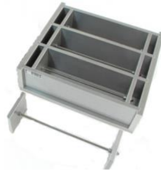
Рис. 5. Форма для виготовлення зразків згідно з ASTM C 878/C 878M-09
