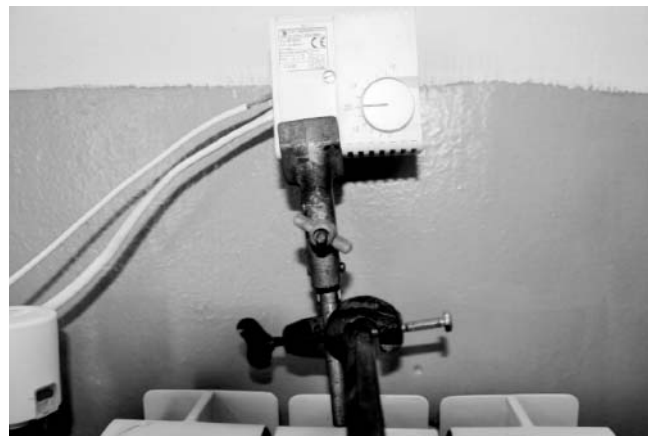
Рис. 4. Положення термостата відносно опалювального приладу: а) положення на висоті H=0 см, ширині A=10 см; б) положення на висоті H=15 см, ширині A=10 см
