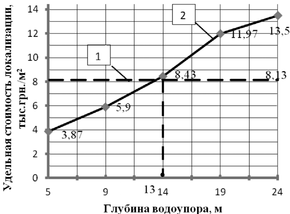
Рис.4. График зависимости удельной стоимости локалізації от глубины заложения водоупора 1 – ГПЭ в сочетании с ПФЗ при отсутствии естественного водоупора; 2 – ПФЗ при наличии естественного водоупора
