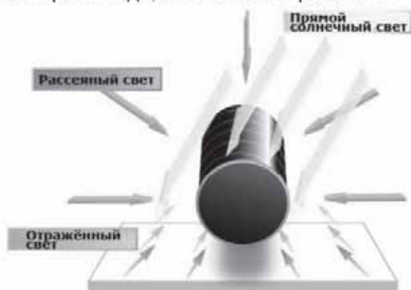
Рис. 1. Устройство и принцип действия цилиндрических солнечных батарей
