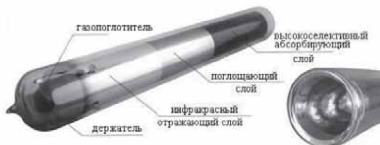
Рис. 2. Устройство вакуумных трубчатых солнечных коллекторов
