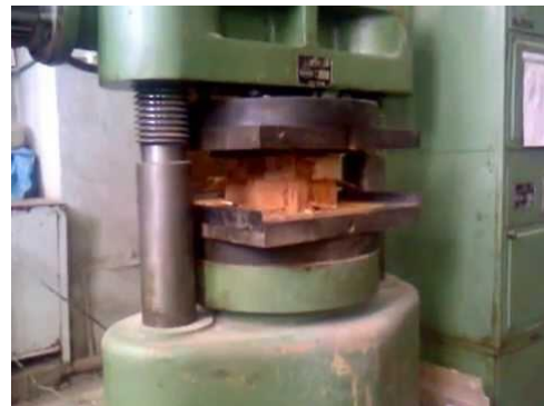
Рис. 5 Фотофрагмент проведения испытания образца на сжатие
