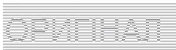
Рис.3. Прихований напис «Оригінал», що утворений зміщенням ліній растру, на першому растровому полі
