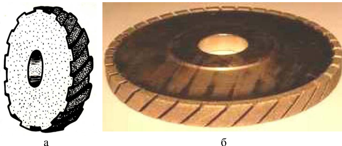
Рис. 8. Внешний вид абразивного (а) и алмазного (б) прерывистых кругов с наклонными впадинами, обеспечивающими непрерывный контакт инструмента с обрабатываемым материалом
