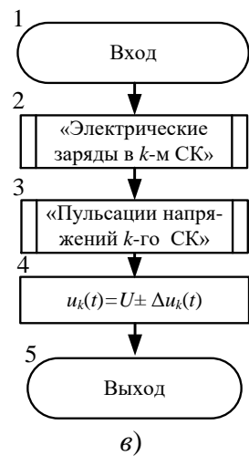
Рисунок 7 – Алгоритмы подпрограмм «Электрические заряды в k-м СК» (а) – расчета мгновенных значений электрических зарядов q_{пк}(t) и q_{нк}(t) , «Пульсации напряжений k-го СК» (б) – расчета пульсаций напряжений – мгновенных значений \Delta u_{пк}(t), \Delta u_{нк}(t) и «Напряжения k-го СК» (в) – расчета мгновенных значений напряжений u_{пк}(t), u_{нк}(t) k-го СК
