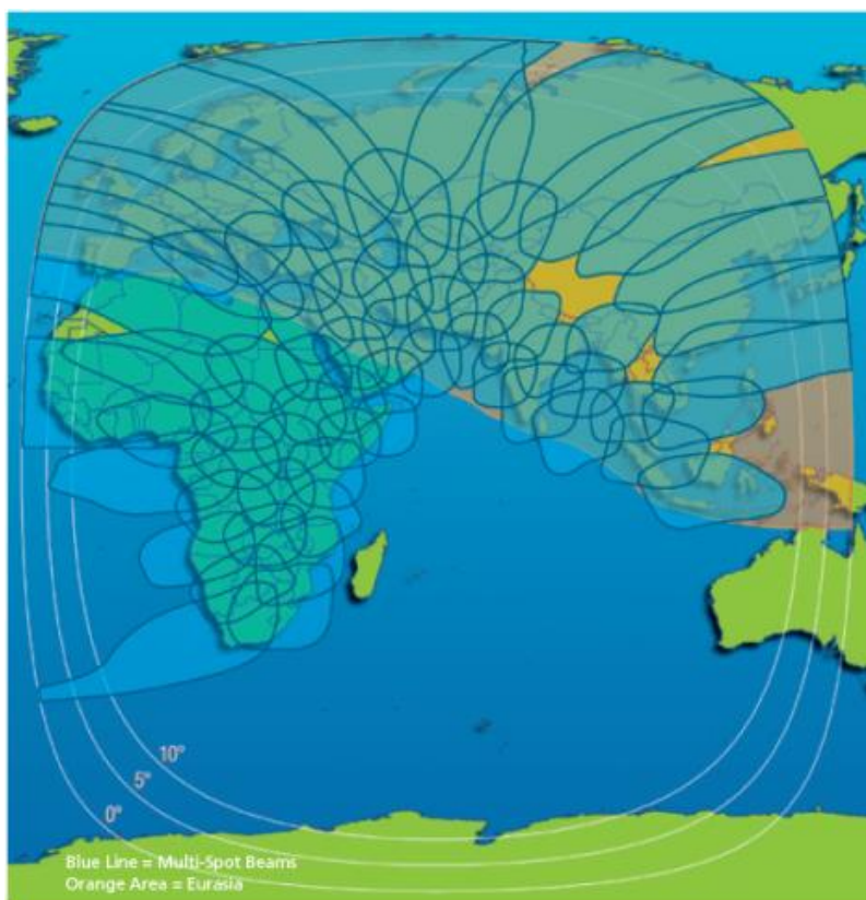
Рисунок 38 – Зона покриття супутника Intelsat 33e в діапазоні Ku
