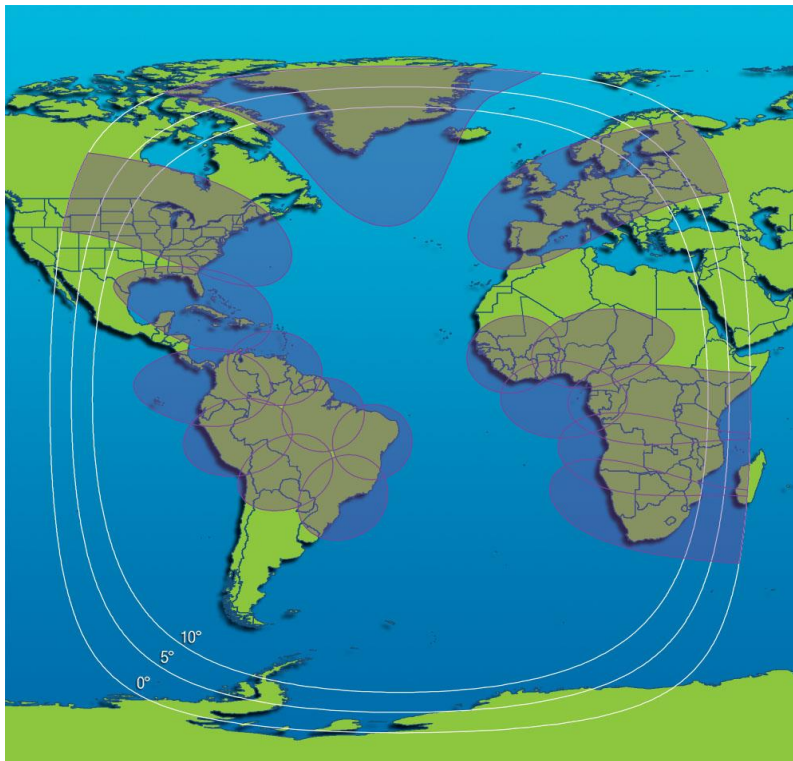
Рисунок 39 – Покриття у діапазоні С, супутник Intelsat 33e
