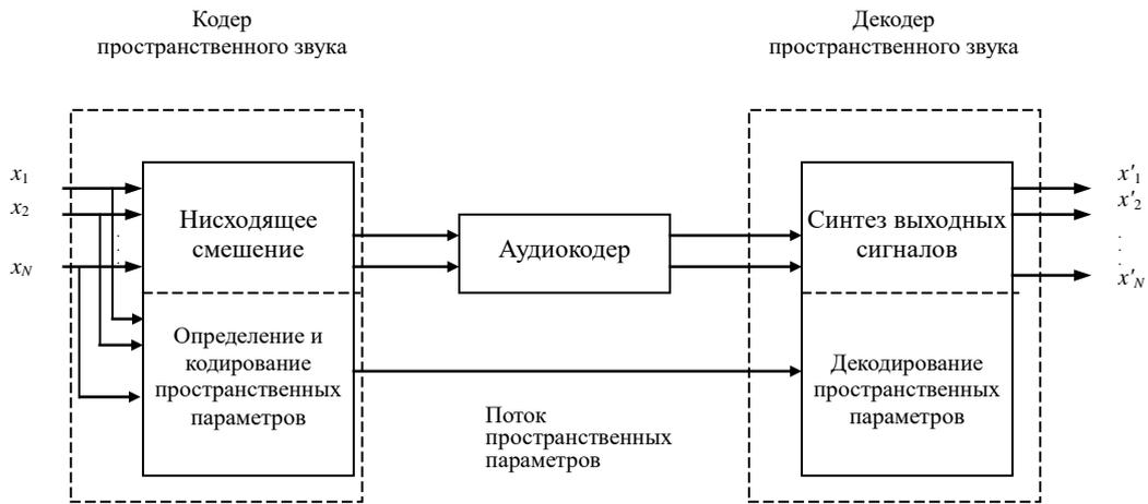
Рисунок 1 – Принцип передачи многоканального звукового сигнала
