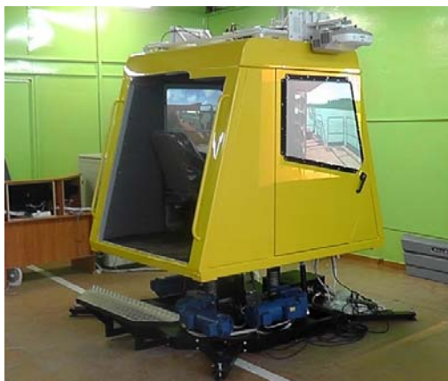
Рис. 2. Кабіна самоскида, яка встановлена на динамічній платформі
