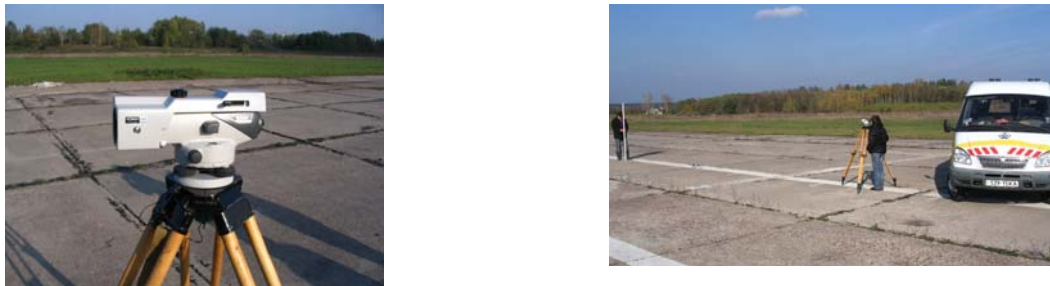
Рис. 3 - Визначення відміток поздовжнього профілю
