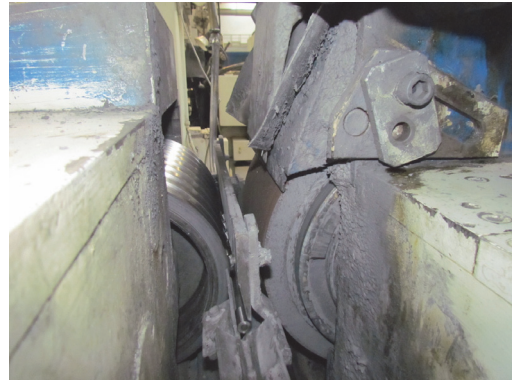
Рис. 3. Робоча зона безцентрово-шліфувального верстату SWaAKM25/1A.
