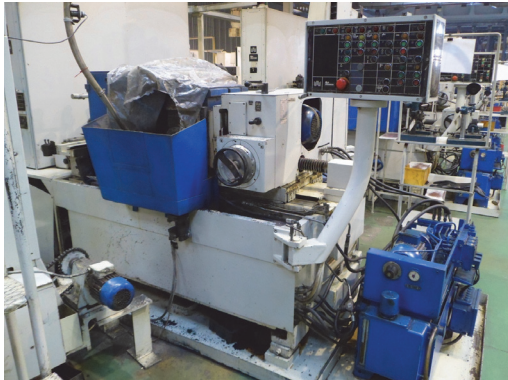
Рис. 2. Безцентрово-шліфувальний верстат SWaAKM25/1A для оброблення конічних роликів.
