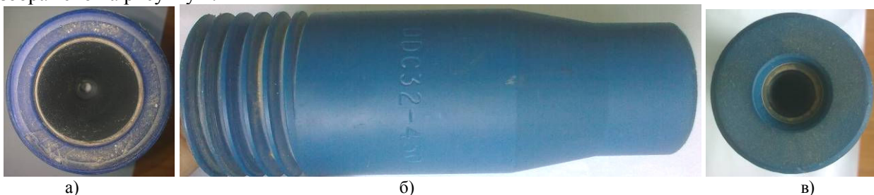
Рис. 2. Абразивоструменеве сопло UDC32–450 форми Вентурі а) вхідна широка горловина; б) вид збоку; в) вхідна вузька горловина.
