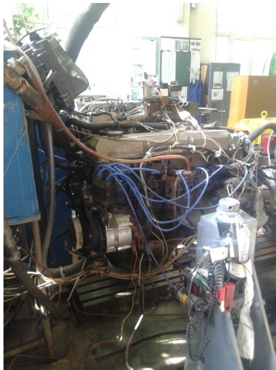
Рисунок 2 – Двигун 6Ч9,5/6,98 (OPEL C30NE)
