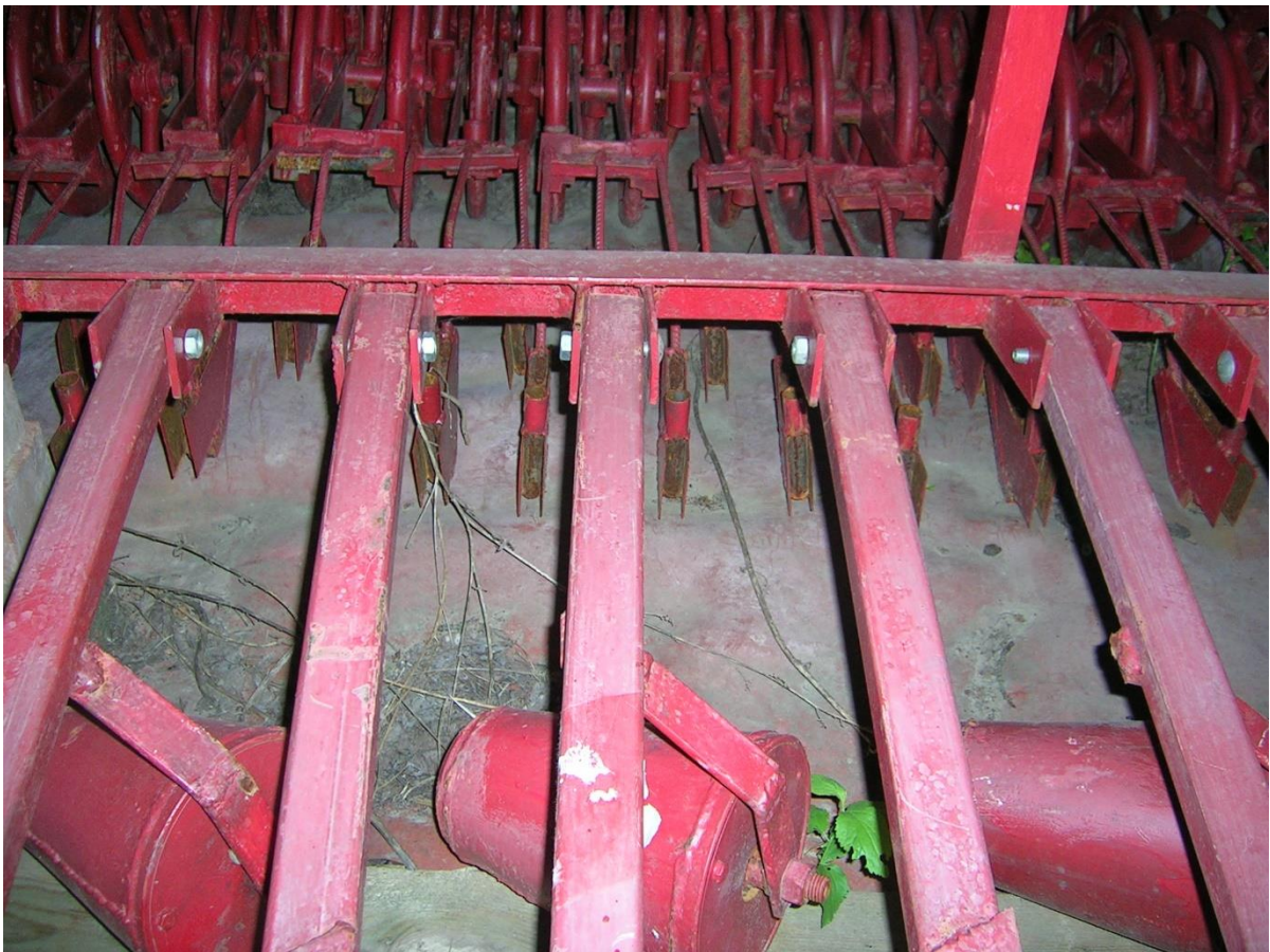
Рисунок 3. – Фрагмент розміщення робочих органів на експериментальному агрегаті для висіву насіння у свіжозораному ґрунті з стабілізацією в ньому водно-повітряного режиму
