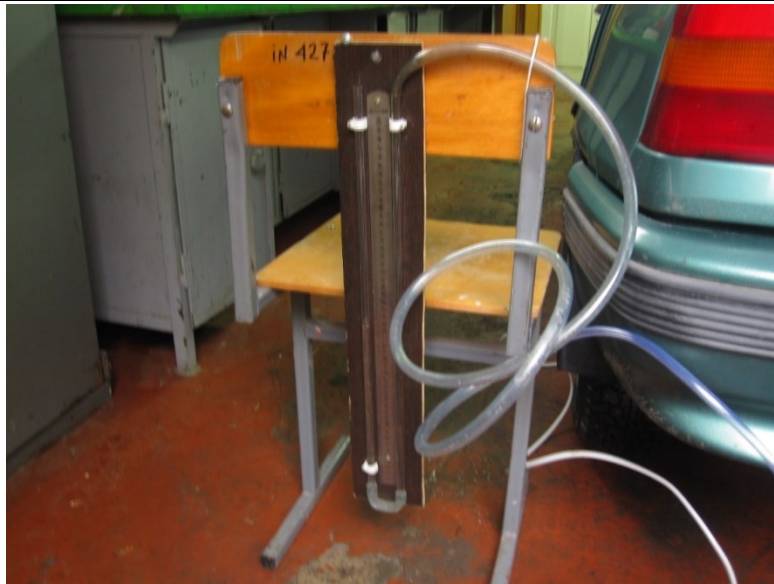
Рис. 6. Пристрій для вимірювання розрідження у системі випуску.
