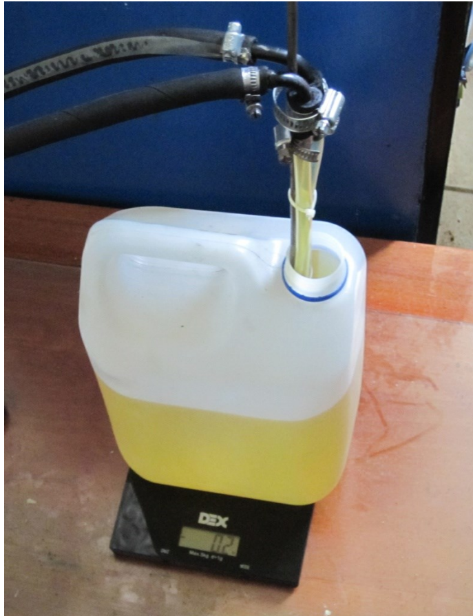
Рис.4. Система для визначення витрати палива ваговим методом
