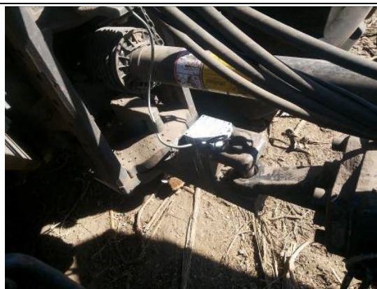
Рис. 2. Місця встановлення акселерометрів
