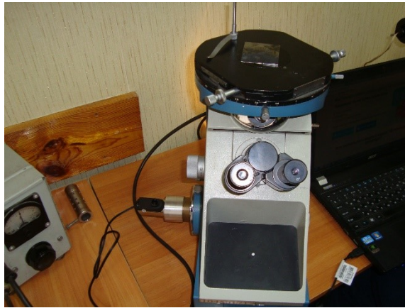
Рисунок 1 – Зовнішній вигляд металографічного мікроскопа ММР-2Р з допоміжним обладнанням під час експериментальних досліджень
