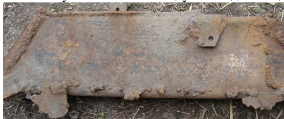
Рисунок 2 – Частина лонжерона основи каркасу кузова обраного для досліджень
