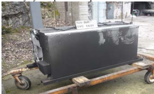
Рис. 11 - Система аккумуляторных батарей (REESS) после проведения испытаний на огнестойчивость, согласно R100
