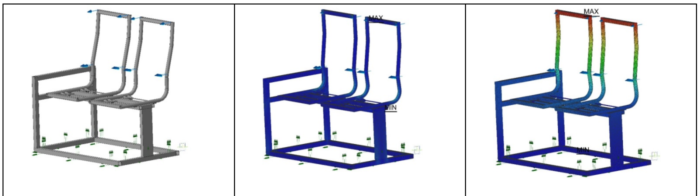
Рис.3. Двомісне пасажирське сидіння моделі СТН-6 з рамою для кріплення а) об'ємна модель ;б) напруження від прикладених сил; в) переміщення від прикладених сил.
