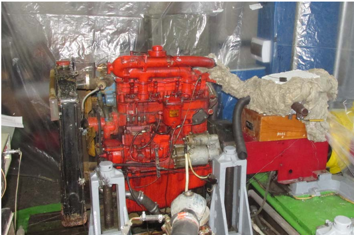
Рис. 1. Загальний вигляд гальмівної установки з дизелем Д-243
