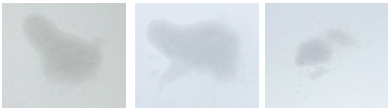
Рис. 3 – П'ятна розпилу ремонтних форсунок
