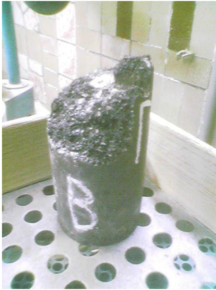
Рисунок 4 - Классический срез при кручении
