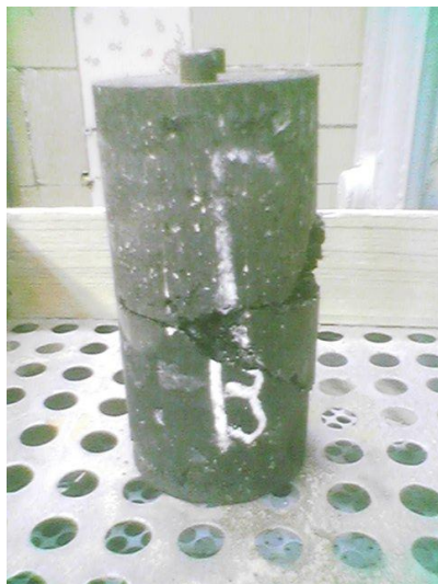
Рисунок 6 - Срез по контакту слоёв
