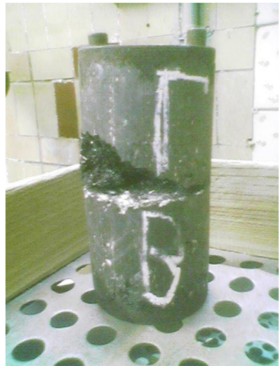
Рисунок 5 - Срез с разрушением закладных частей
