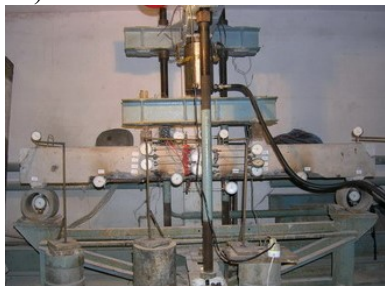
Рисунок 2 - Схема розташування приладів при випробуванні підсиленої балки:
