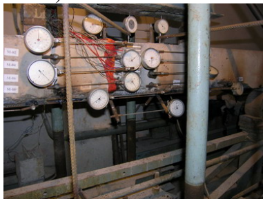
Рисунок 2 - Схема розташування приладів при випробуванні підсиленої балки:
