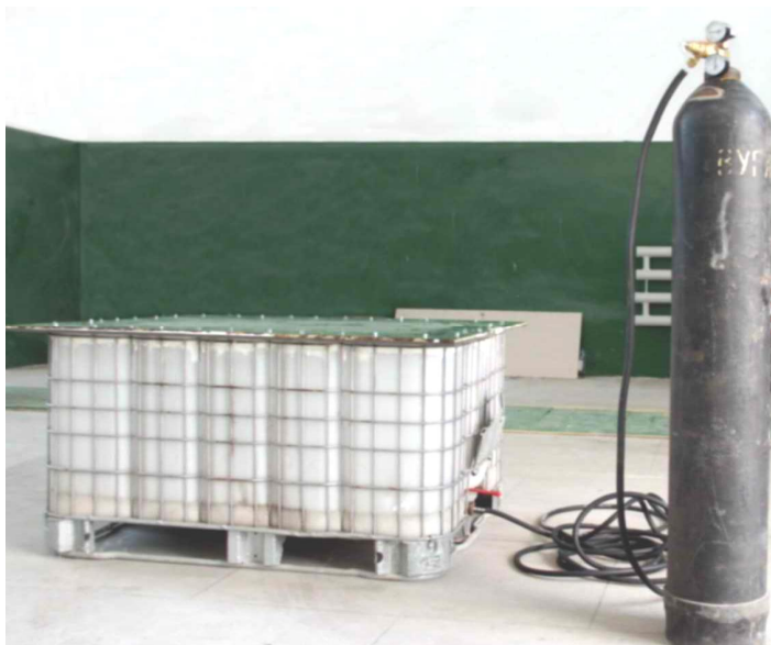
Рисунок 1 - Зовнішній вигляд установки для прискореної карбонізації цементного каменю
