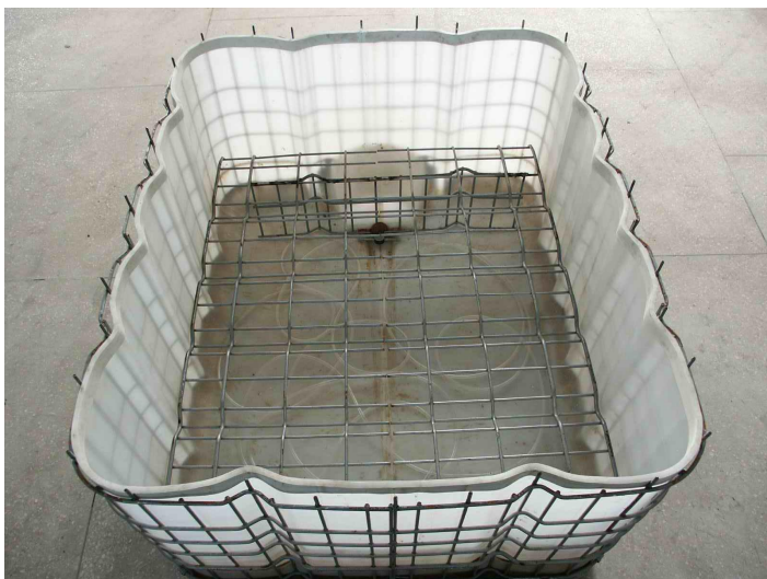
Рисунок 2 - Внутрішня будова установки для карбонізації
