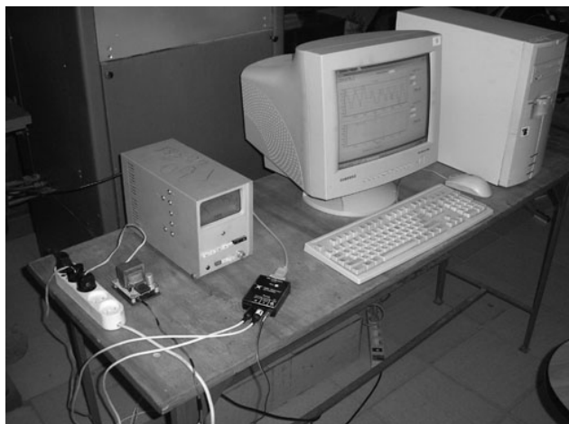
Рисунок 2 - Схема і загальний вигляд електронної частини установки для визначення параметрів тріщиностійкості
