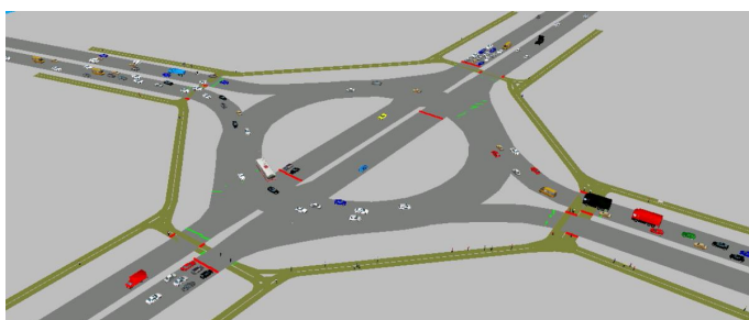
Рисунок 10 – Движение транспортно-пешеходных потоков при разрезе центрального островка вдоль высоконагруженной магистрали
