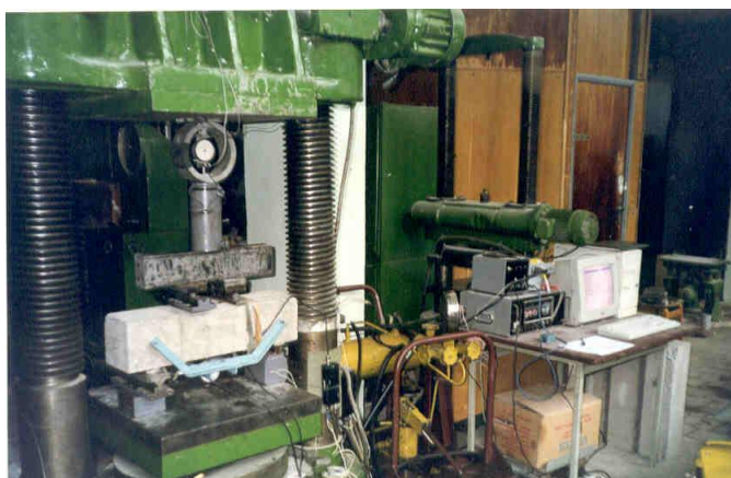
Рисунок 1 – Випробування бетонних призм за схемою чистого згину
