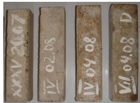
Рисунок 5 – Виготовлені цементобетонні балочки
