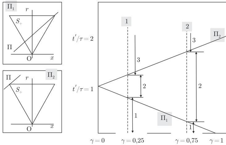
Рис. 2. “Характеристические” прямые на плоскости переменных  $t'/\tau$ ,  $\gamma$ . Затененные цифры 1, 2 над штриховыми линиями означают номер столбца “матрицы рисунков” рис. 3, цифры справа от штриховых линий соответствуют одному из вариантов положения прямой  $\Pi$  по отношению к области  $S_+$
