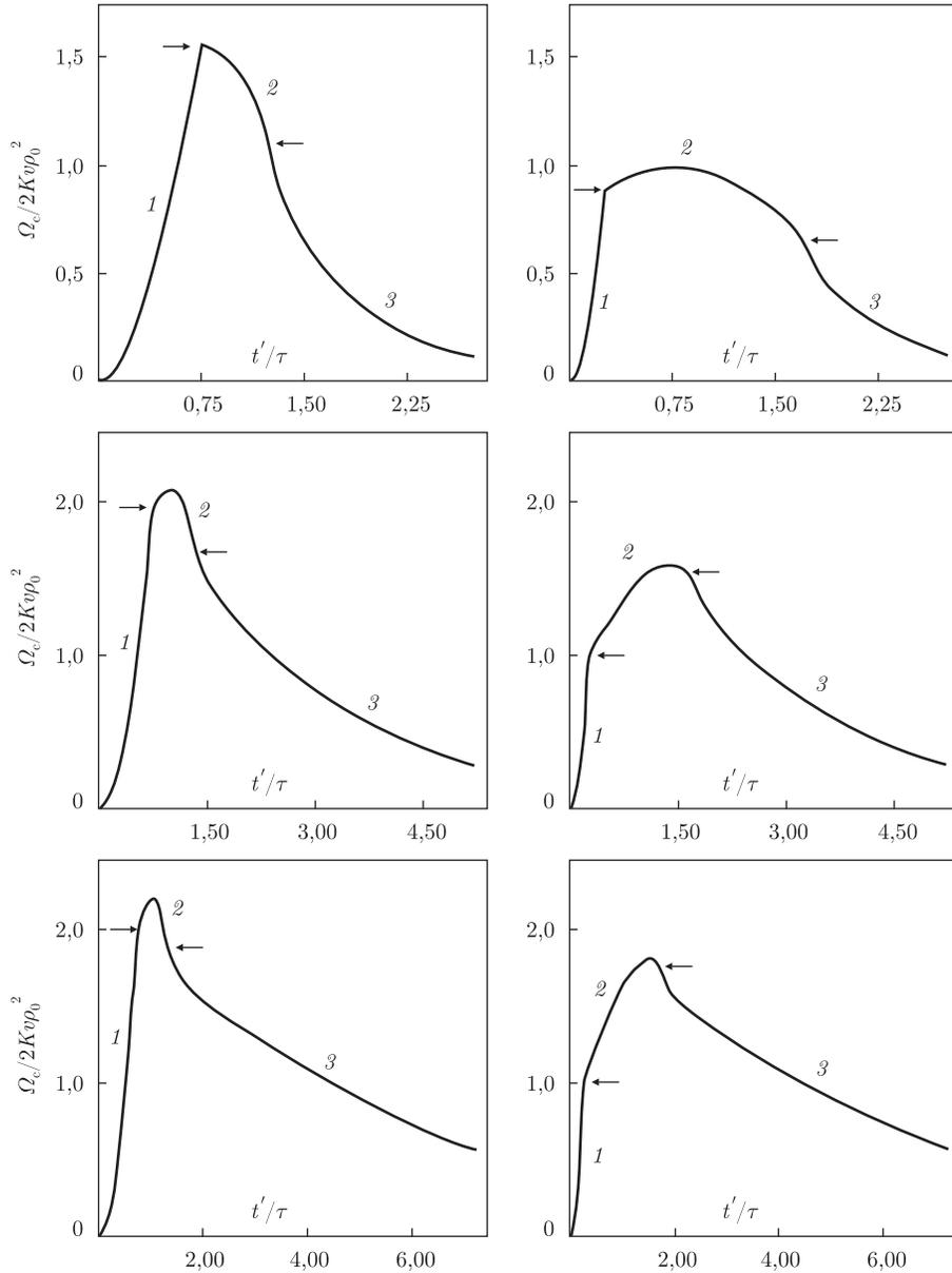
Рис. 3. Форма импульса смещения в дальней зоне для разных значений  $T_c/\tau$ ,  $\gamma$ . Номер столбца “матрицы рисунков” соответствует номеру сечения  $\gamma = \text{const}$  рис. 2, стрелки отделяют участки графика с разной функциональной зависимостью от  $t'/\tau$ . Каждая строка “матрицы рисунков” соответствует фиксированному значению  $T_c/\tau$ , для первой строки  $T_c/\tau = 0,725$ , для второй  $T_c/\tau = 2,125$ , для третьей  $T_c/\tau = 4,225$
