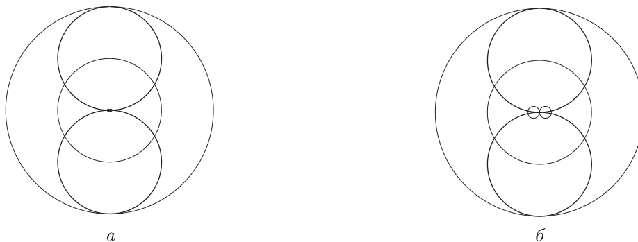
Рис. 4. Нормированная диаграмма направленности эоловых тонов, возникающих за счет осцилляций подъемной силы и силы сопротивления: a – Re = 100 ; б – Re = 400
