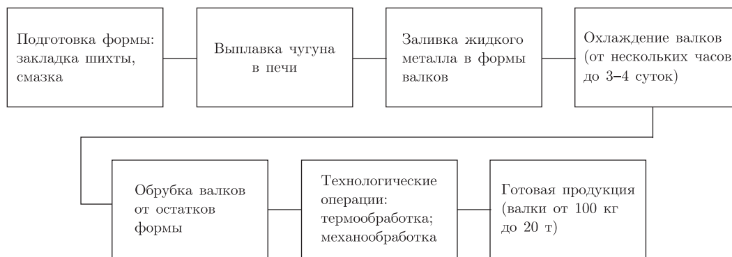
Рис. 1. Принципиальная схема технологии производства чугунных валков
