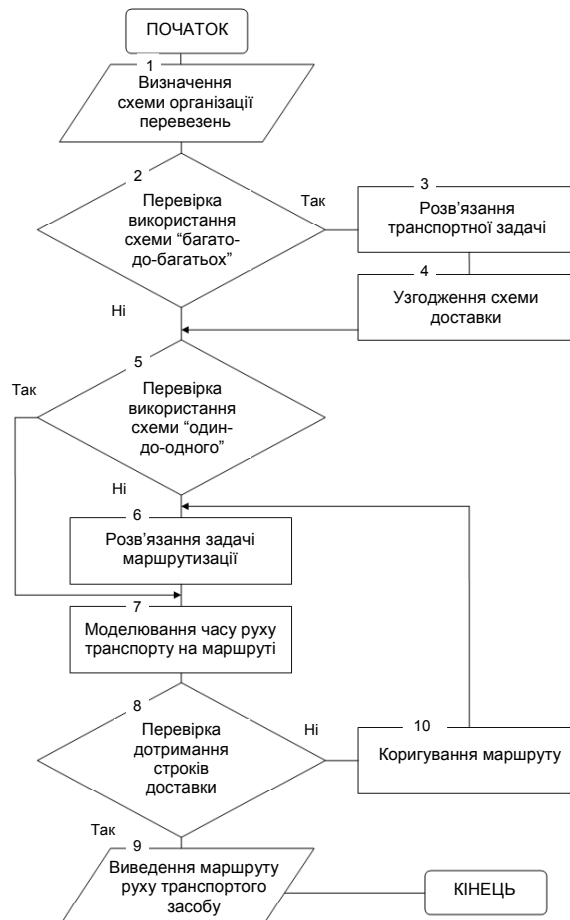
Рис. 2. Загальний алгоритм планування вантажних автоперевезень
