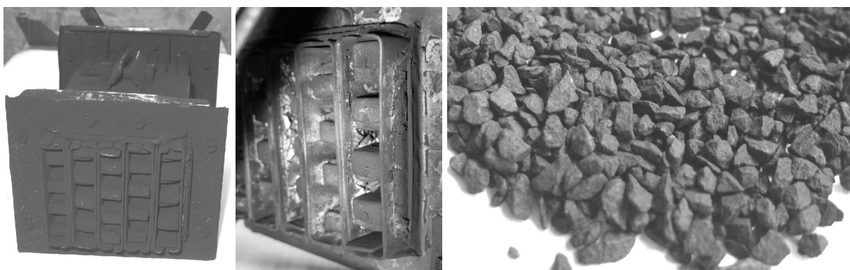
Рис. 4. ДМЦ ФЭ и насыпной цеолит после моторных испытаний
