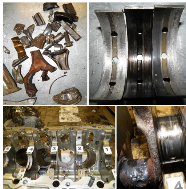
Рис.7. Полное разрушение двигателя (вверху) с чрезвычайными повреждениями большинства коренных и шатунных вкладышей, коленчатого вала и множественными пробоями блока цилиндров (внизу) - результат длительной работы двигателя на мощностных режимах с неисправной системой смазки
