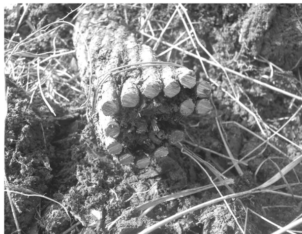
Рис. 6. Кабель Индоевропейского телеграфа, проложенный по дну Керченского пролива
