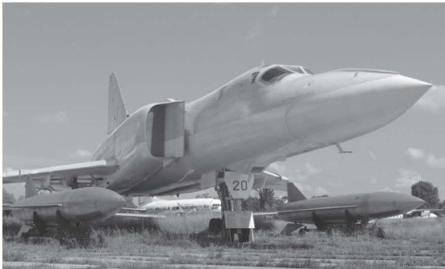
Рис. 5. Стратегічний бомбардувальник Ту-22М2 № 3146253 з крилатими ракетами Х-22М під крилами (ДМА). Заводський номер знаходиться у ніші передньої опори шасі
