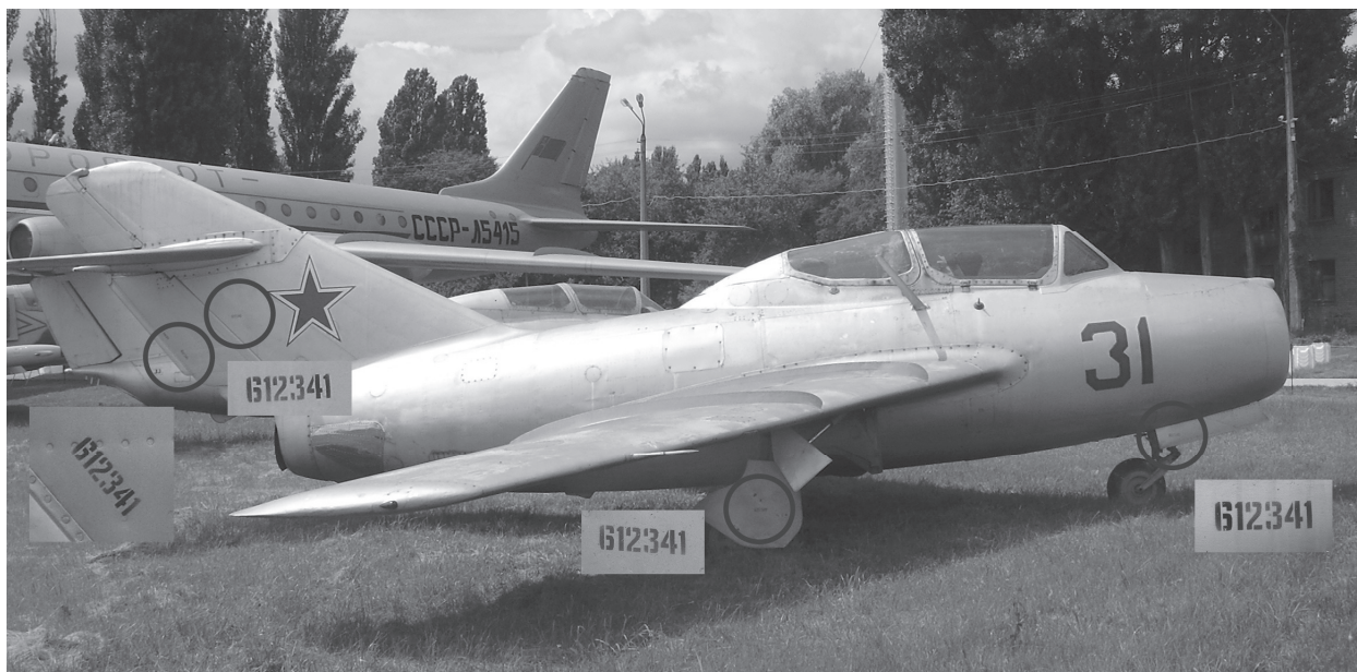
Рис. 2. Розміщення формулярних номерів на навчально-тренувальному винищувачі УТІ МіГ-15 чеської будови (ДМА)
