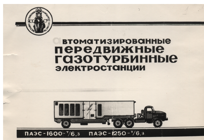
Фото 1. Передвижная электростанция на базе конвертированного газотурбинного авиадвигателя АИ-20
