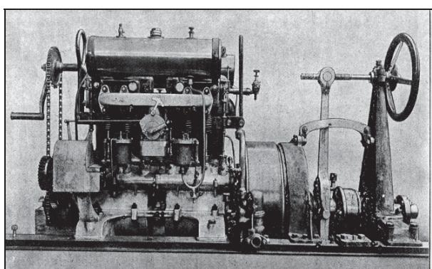
Рис. 6. 25-сильный судовой двигатель Луцкого
