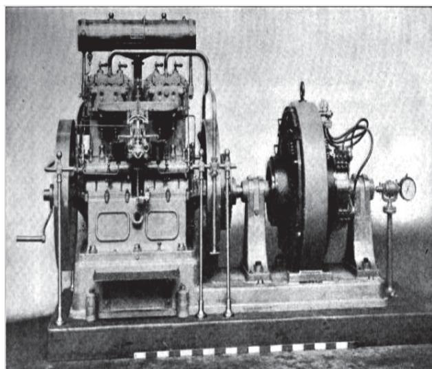
Рис. 7. 50-сильный судовой двигатель Луцкого
